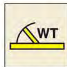
'B' Class watertight fire door 6758 EE, GG & JJ
